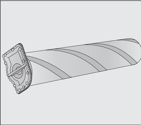
Die Elektrobürste ist mit der Softwalze Hardfloor Care für das Saugen von empfindlichen Hartböden geeignet.
