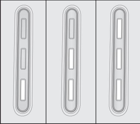
Wenn der Akku lange nicht genutzt wurde und entladen ist, fällt er in einen Sicherheitsmodus. Beim Laden in der PowerUnit reagiert die Anzeige Akku-Ladezustand dann erst nach ca. 30 - 60 Minuten.
